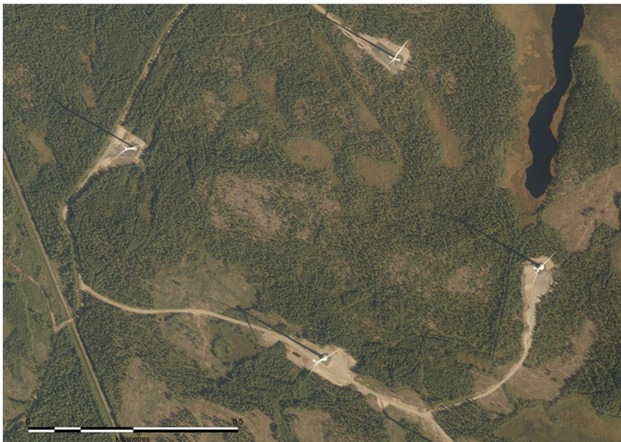
Kuva 67. Ilmakuvassa näkyy toiminnassa olevia tuulivoimaloita. Tuulivoimaloita varten on rakennettu huoltotiet ja nostokentät. Tuulivoimaloiden ympäristössä ja välialueilla aikaisempi maankäyttö on säilynyt ennallaan.
